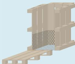
**4** Découper le grillage aux dimensions du composteur et le disposer dans le fond. Il évitera aux nuisibles de s'introduire et permettra de garder la matière compactée.
